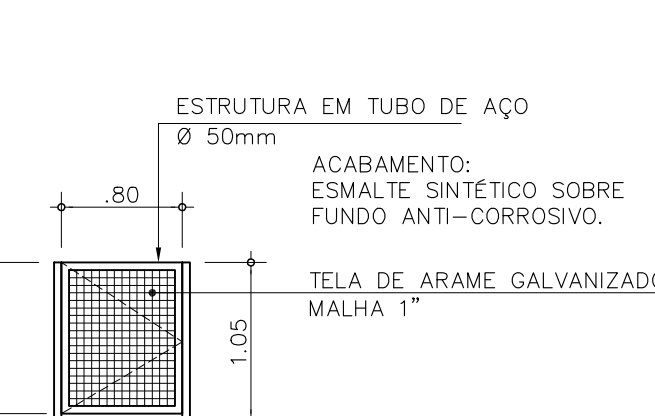
PT3 ELEVÇÃO ESC. 1:50 PORTÃO TUBULAR DE AÇO E TELA 1 FOLHA DE ABRIR QUANT.: 2
