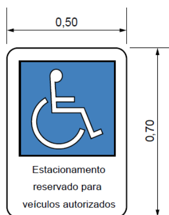
Sinalização de estacionamento para P.C.D
